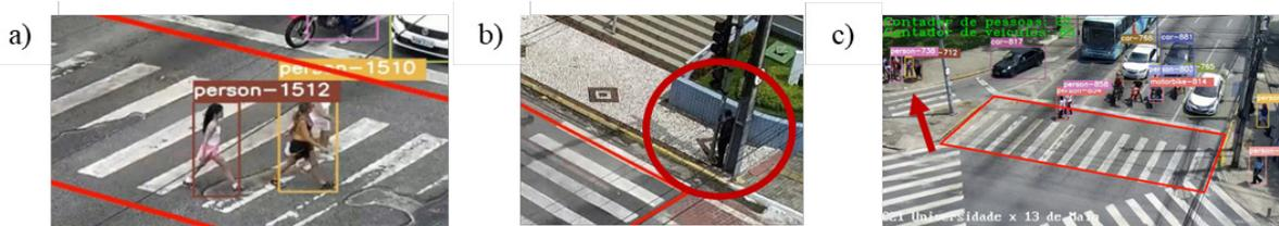
**Figura 14.** Exemplos de possíveis erros de medição do algoritmo: (a) erros por aglomeração, (b) erros por objetos e (c) erros por geometria.
