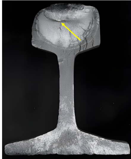
Figura 1. Seção transversal de uma fratura de trilho ocasionada por inclusões de impureza no boleto do trilho durante o processo de fabricação [adaptado de: Li, Doh e Manogaran, 2023].
